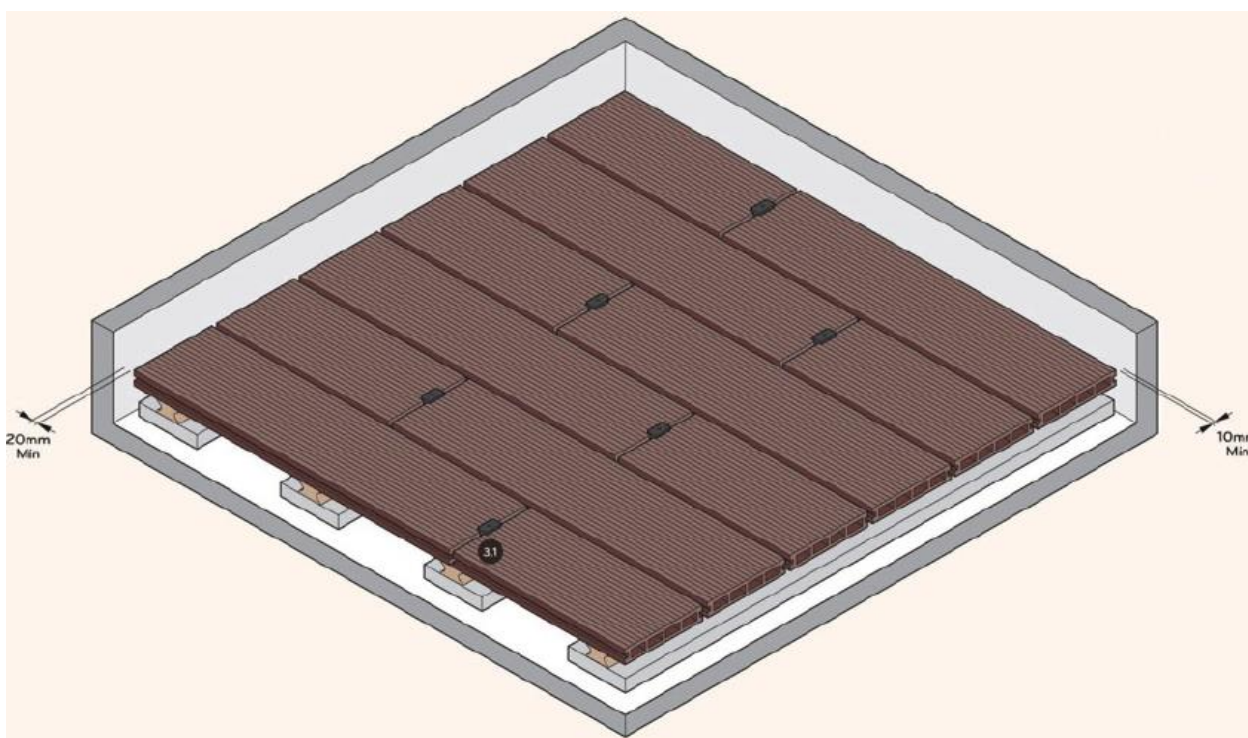
Obr. 7 – pokládka WPC desek s dodržением dilatačních mezer
